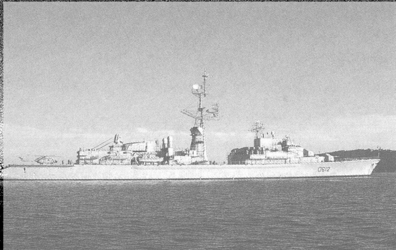
左图：“特维利”级导弹驱逐舰（照片中的是“德格拉斯”号）通过“马拉丰”火箭发射鱼雷系统和两个舰载直升机执行海洋反潜任务。
