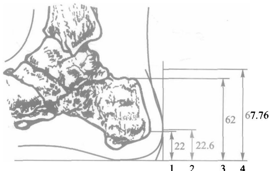
图 2-4 250 号脚与楦的后跟部位对应的关系
