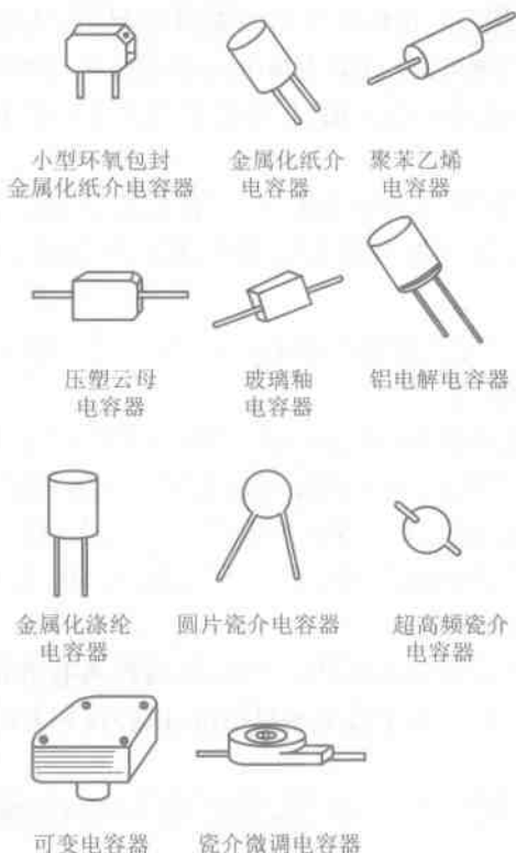
图 1.7 常用电容器外形示意
