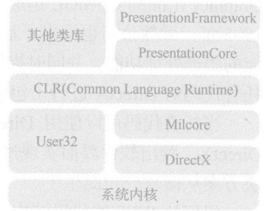
图 1-8 Windows 系统架构
