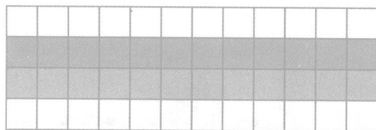
图 1-4 使用抗锯齿技术以及 ClearType 技术绘制的直线效果
