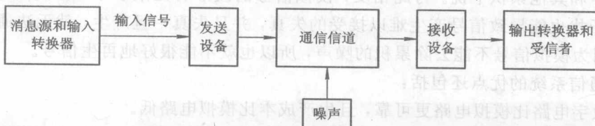
图 1.1 通信系统模型
