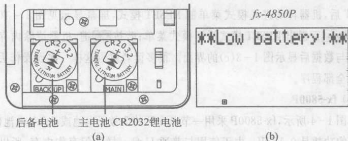
图 1-2 fx-4850P 的两块 CR2032 锂电池与电池电量低显示
