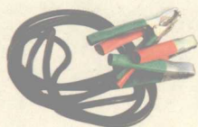
蓄电池跨接线
