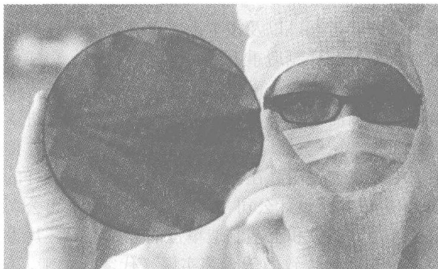
图 1.6 一个 12 英寸晶圆与人脸大小的对比
