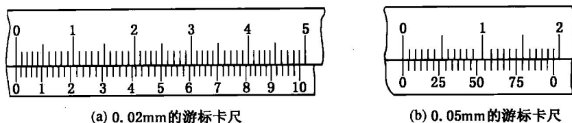
图1-5 游标卡尺的刻线原理
