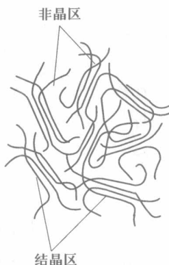
图 1.7 高聚物的聚集态结构模型
