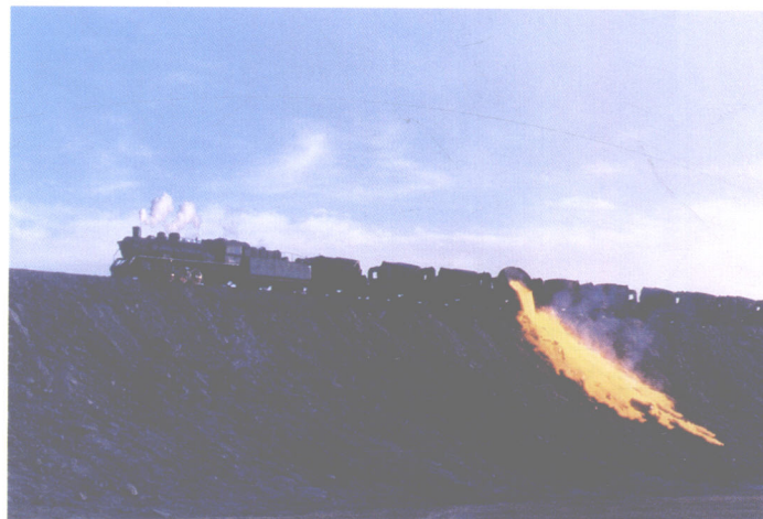
▲ 包钢的渣山上，由上游机车牵引的钢渣专列正在倾倒钢渣。（1999 年 2 月） In Baotou Steelworks, a steel scoria train hauled by SY was unloading steel scoriae. (February 1999)
