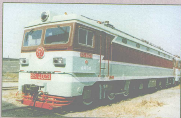
韶山 3 型4000系电力机车 客、货两用干线机车，1992年批量生产， 持续功率4320kW，最高速度100km/h。
