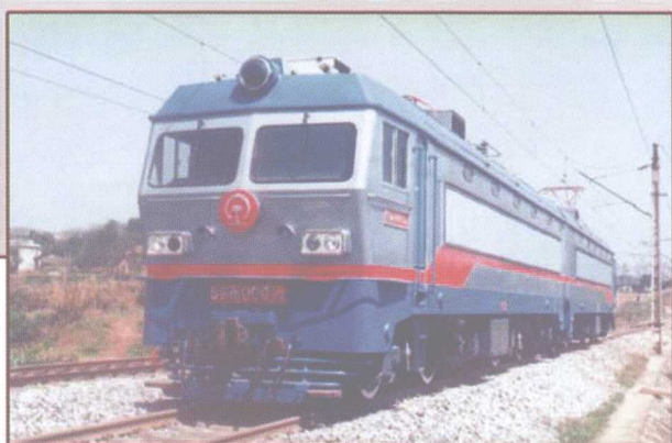
韶山 4B 型电力机车 干线货运机车，1995年研制成功， 持续功率 2 \times 3200\text{kW} ，最高速度 100\text{km/h} 。
