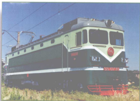
韶山 1 型电力机车 客、货两用干线机车，1958年起生产， 持续功率3780kW，最高速度90km/h。
