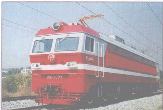
韶山 100 型电力机车 干线货运机车，1994年研制成功， 持续功率4800kW，最高速度100km/h。
