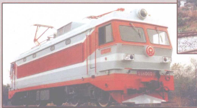
韶山 6 型电力机车 干线客运机车，1990年研制完成， 持续功率 3200\text{kW} ，最高速度 140\text{km/h} 。
