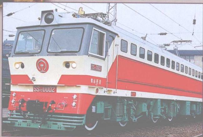
韶山 7C 型电力机车 客、货两用干线机车，1998年试制成功， 持续功率4800kW，机车最高速度120km/h。
