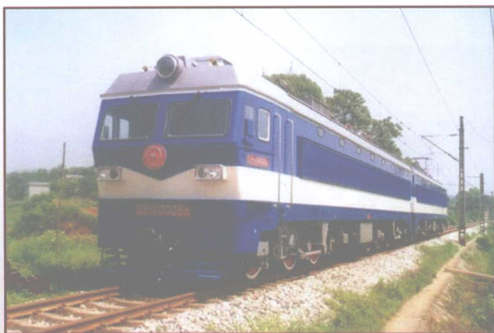
韶山 3B 型电力机车 干线货运机车，2002年起生产， 持续制功率 2 \times 4320\text{kW} ，最高速度 100\text{km/h} 。
