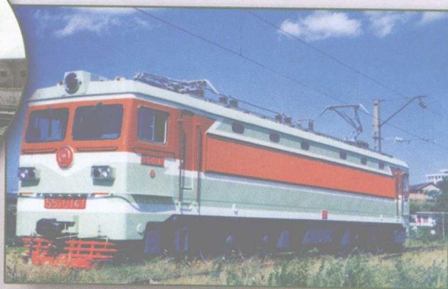
韶山 3 型电力机车 客、货两用干线机车，1978年研制成功， 持续功率4320kW，最高速度100km/h。
