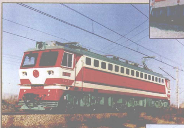
韶山 7B 型电力机车 干线货运机车，1998年生产， 持续功率4800kW，最高速度100km/h。
