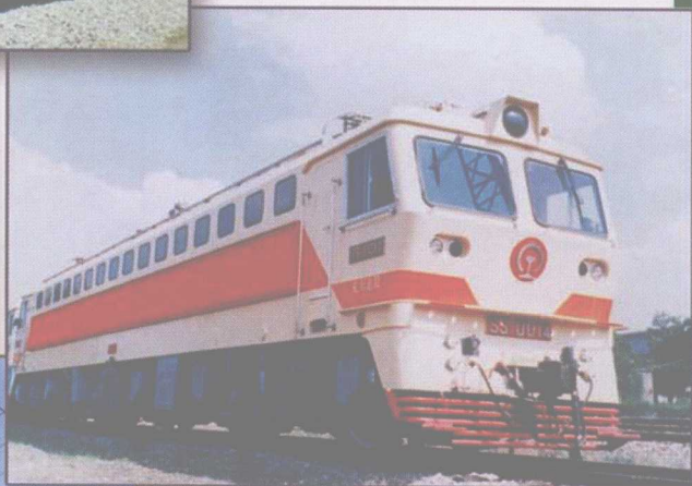
韶山 100 型电力机车 客、货两用干线机车，1992年落成出厂， 持续功率4800kW，最高速度100km/h。
