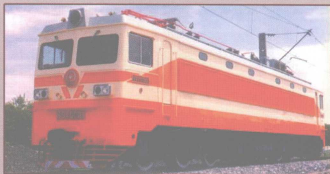
韶山 8 型电力机车 客、货两用干线机车，1991年试制成功， 持续功率 4800\text{kW} ，最高速度 100\text{km/h} 。
