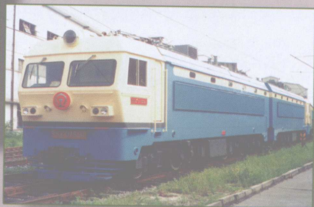
韶山 4 型电力机车 干线货运机车，1985年研制成功， 持续功率 2 \times 3200 kW，最高速度100km/h。
