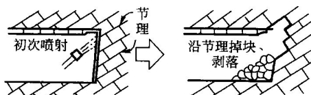
图 2-5 节理发育围岩中的喷射
