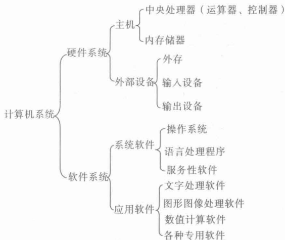
图 1-1 计算机的基本构成
