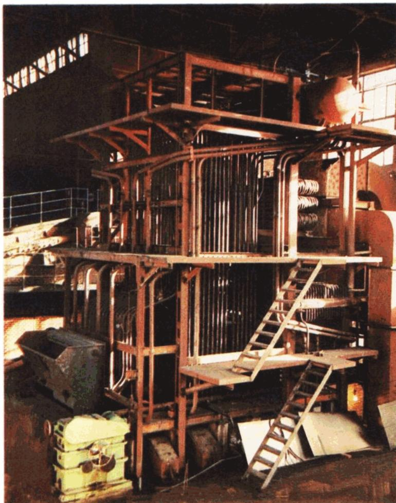
鞍山锅炉厂生产的DHL 600-10/130/70-A II型锅炉是一种单锅筒横置式鳞式链条炉排自然循环高温热水锅炉。
