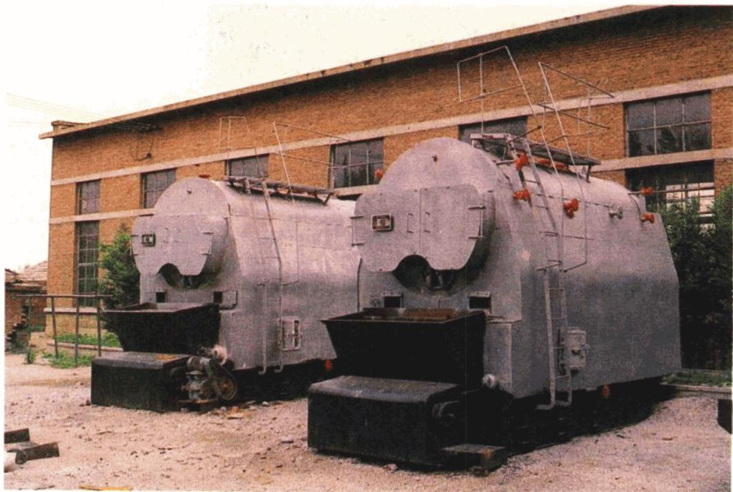
DZW 1-7-AI 蒸汽锅炉是开原锅炉厂研制的一种新产品，适用于生产用蒸汽和生活采暖。
