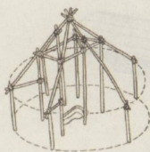
● 仰韶文化的圆形房子（左：平面图 中：构架示意图 右：复原图）
