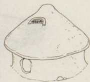
● 仰韶文化的圆形房子（左：平面图 中：构架示意图 右：复原图）
