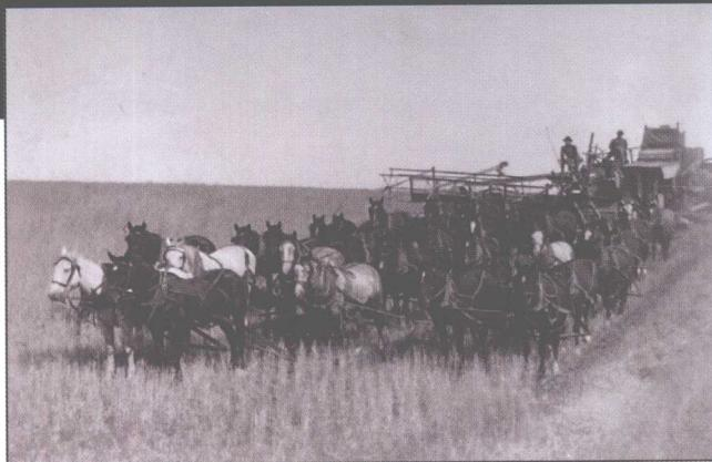
收获庄稼要经过收割(割秆)、脱粒(将种子从茎秆中脱离出来)、扬场(种子与麦杆或谷壳分开)等步骤。第一台脱粒设备发明于1786年,第一台成功的收割设备发明于1851年。在19世纪80年代,休·维克托·麦凯(参见第17页)将收割机、脱粒机、扬场机结合到一起,发明了第一台联合收割机。
