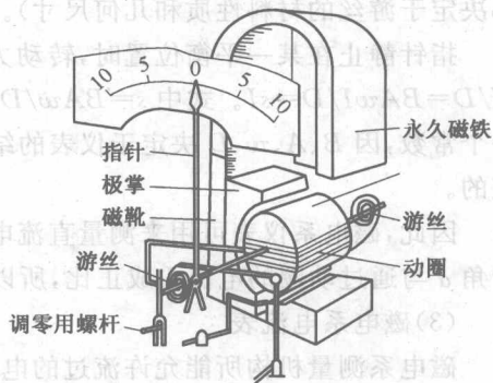
图 1-2 磁电系测量机构的结构
