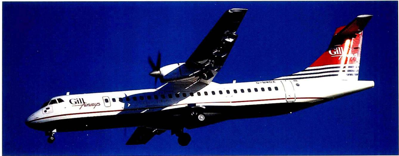
区域运输机公司注意到空运市场的发展和客户的需求后，1985年开始研制这种较大的72座ATR 72-200飞机，1988年10月27日进行了首次飞行。到1989年4月，3架原型机都进行了试飞。ATR 72飞机与ATR 42结构相同，ATR 72机身加长4.5米；拥有加强型机翼和普拉特·惠特尼加拿大公司的功率更大的PW124B涡桨发动机；载油更多，航程更远。客舱可载客64~74人。区域运输机公司首次在ATR 72飞机上采用了复合材料制造的机翼和蒙皮。
