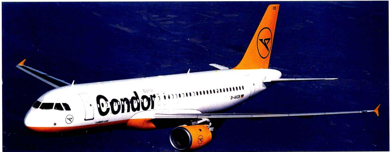
空中客车工业公司看到美国垄断客机市场的局面已被空客 A300 和 A310 飞机打破，便决定研制可以与波音 737 系列和 MD-80 系列飞机进行竞争的空客 A320 飞机。并决定尽可能地采用先进技术来大幅度降低运营成本，同时努力说服世界飞机市场接受新事物。A320 的设计可以追溯到 70 年代初期欧洲对短程飞机的研究。1981 年，空客公司研制 A320 飞机时决定使用当时极先进的电传操纵系统和选择双发新型涡轮风扇发动机。最初提出了三种机身长度方案，最终在图卢兹决定只生产两种，即 130~140 座的 A320-100 飞机和 150~160 座的 A320-200 飞机。
