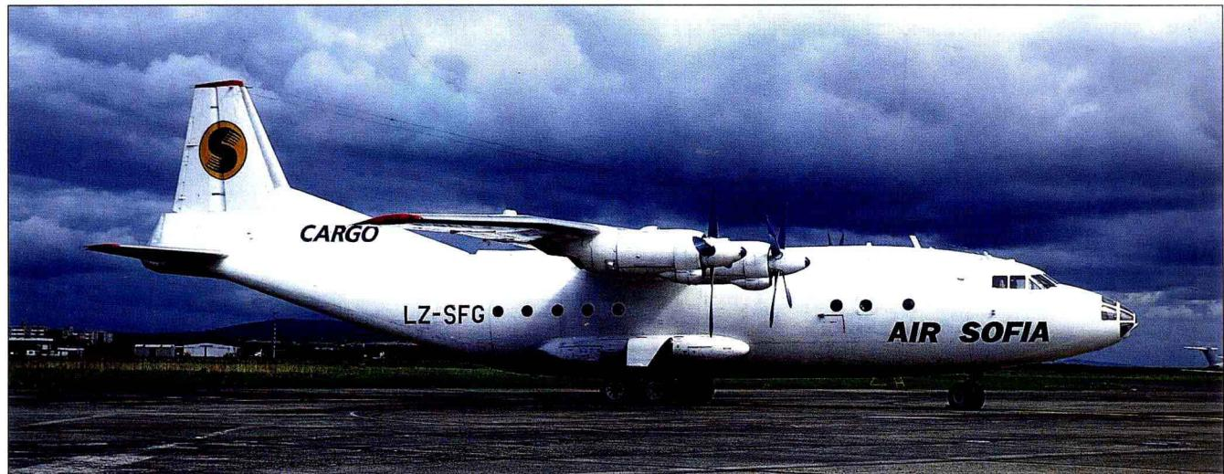
**安**东诺夫设计局从1955年开始研制双涡轮螺旋桨发动机的安-8飞机，北大西洋公约组织称其为“帐篷”。安-8是一种新型战术运输机，特点是高机翼、后货舱门、“重”尾翼，用于简易机场起降的起落架，并装有一台地形测绘雷达。安-8飞机是作为军用运输而设计的，仅制造了100架。70年代安-8停止使用，取而代之的是运量更大的大型飞机。然而到了90年代，又有几架安-8飞机作为小型货机出现在前苏联各地。
