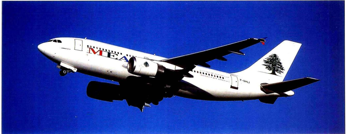
使用空中客车A300飞机的客户，在运营中都感到需要一种小型、短程空客飞机。空中客车工业公司最初计划生产一种名为**A300B10**的飞机，瑞士航空公司、汉莎航空公司和东方航空公司对这种飞机表示感兴趣。1978年，设计方案公布时定名为**A310**。其主舱有11个隔框，机身比A300飞机短，机身宽度相同，采用新技术机翼，改进了起落架，增加了复合材料的使用。A310飞机标准驾驶舱是双人制电子飞行仪表系统驾驶舱，可选择使用的发动机型号包括通用电气公司的CF6、普拉特·惠特尼公司的JT9D和罗尔斯·罗伊斯公司的RB.211涡轮风扇发动机，但是在订货的客户中还没有一家选择罗尔斯·罗伊斯公司的发动机。
