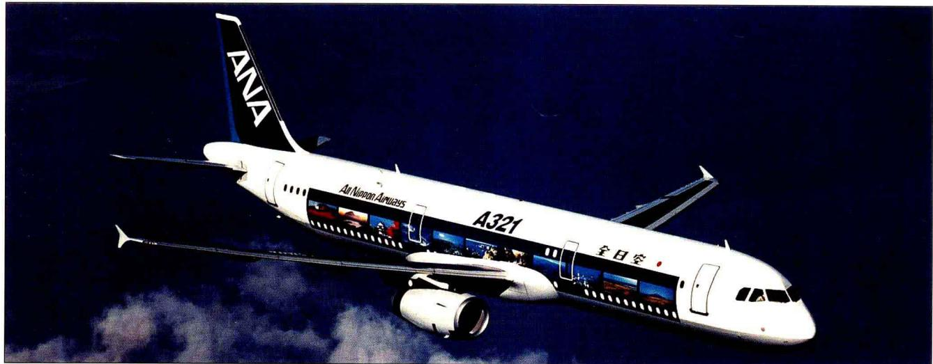
在研制空客 A320 发展型的最初几年里，空客公司设计的载客量更大的机型被称为“加长的 A320”或“A320 加长”，1989 年 11 月，开始正式研制时定名 A321。A321 飞机是 A320 变化最小的改进型，只修改了机翼，增加了使用重量和安装了功率更大的发动机。A321 的机身比 A320 飞机长 6.93 米(273 英寸)，机身中部和起落架改为加固型，重新设计了后缘襟翼。机身加长的 A321 正常载客 176~185 人，机翼前面和后面 2 个锥体使客舱的 4 个紧急出口改在机翼前缘和后缘旁边。
