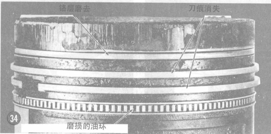
图 34 所示是油环圆刮环磨损到波形弹簧处, 同时波形弹簧严重磨损。弹簧在这种状态下由于与缸壁接触而磨损。一个在这种状态下磨损的油环不再有控制润滑油的作用。
