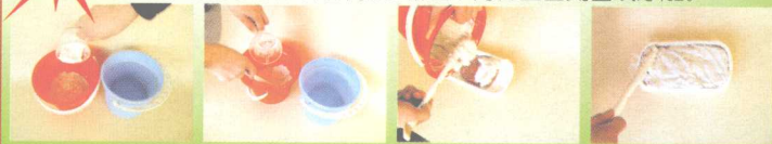
1. 倒上石膏粉 2. 倒上适量的水 3. 水与石膏粉调和 4. 制成石膏板
