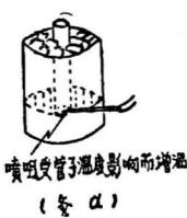
这个炉子可以同时从三个噴嘴将溶液噴出。这样可以节约用炭，充分利用火力，可以使催化剂的顆粒大量进入空中。
