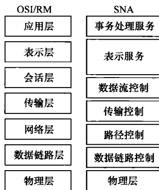
图 1.4 IBM SNA 体系结构
