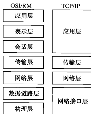
图 1.2 TCP/IP 体系结构
