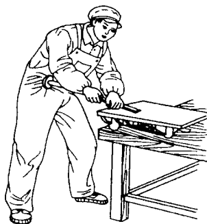
图 1.16 平面刮刀的挺刮法
