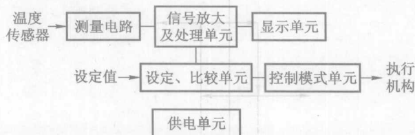
图 1-1 温度显示仪表原理框图
