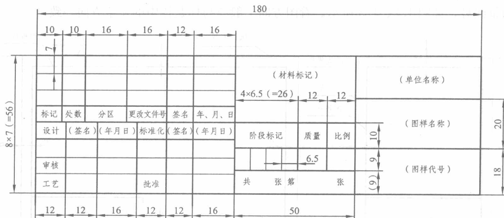
图 1.5 标题栏的格式尺寸 (GB/T10609.1—1989)
