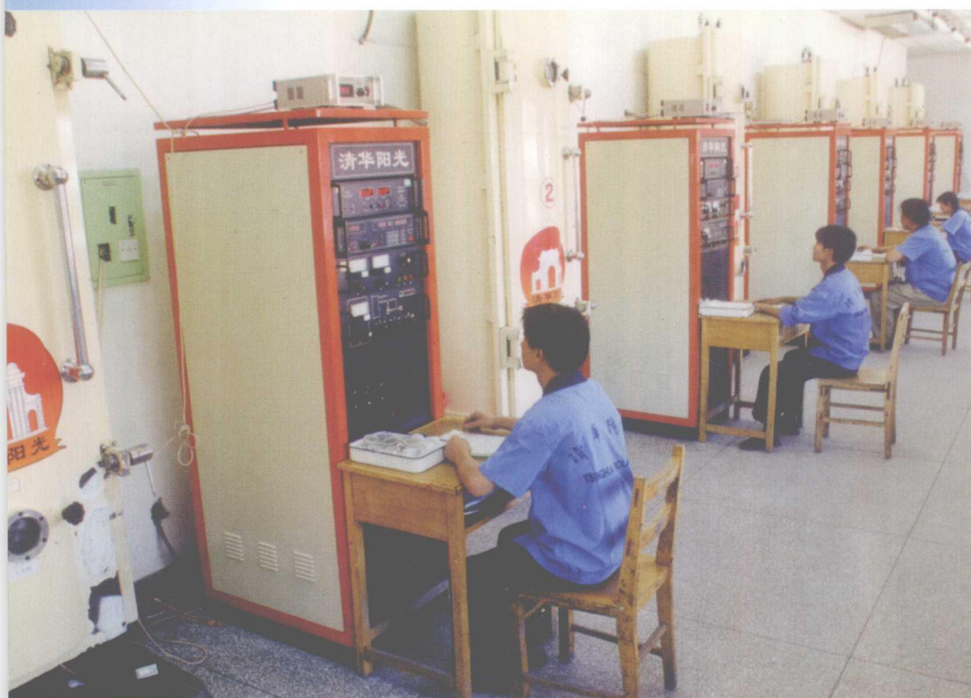
▲ 清华阳光太阳热水器 真空管镀膜车间
