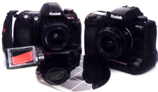
一块晶圆可以切割出数片有用的影像传感器
