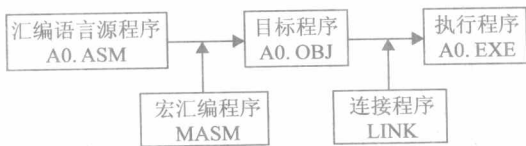
图 1-4 源程序、汇编程序和目标程序间的关系
