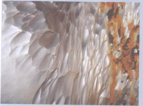
混流式水轮机叶片背面的磨蚀（龚嘴水电站）
