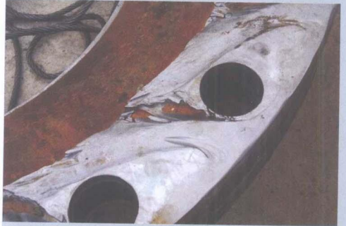
水轮机抗磨环受磨蚀破坏情况（冷竹关水电站）
