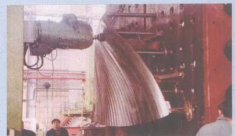
五轴数控铣床加工水轮机叶片
