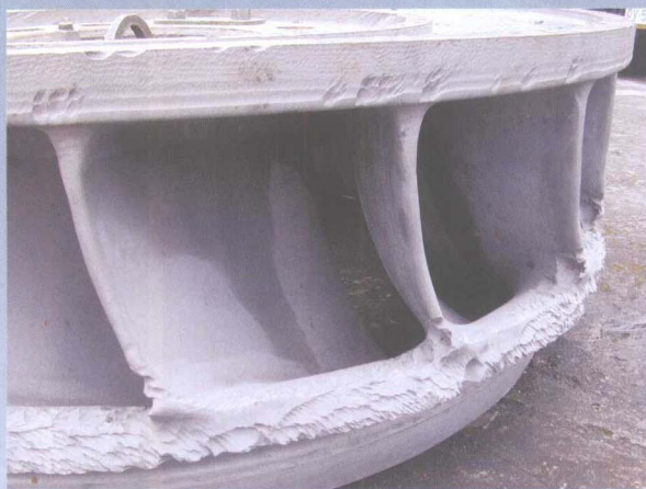
台湾电力公司水轮机转轮磨蚀破坏情况
