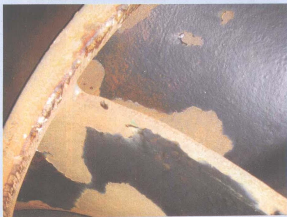
磨损的转轮下环和叶片聚氨酯保护层
