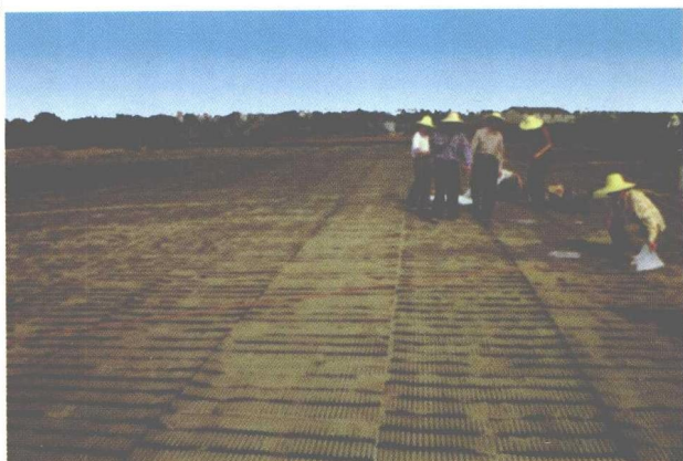
土工格栅应变测试
