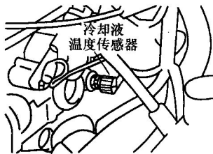
图 1-16 冷却液温度传感器安装位置
