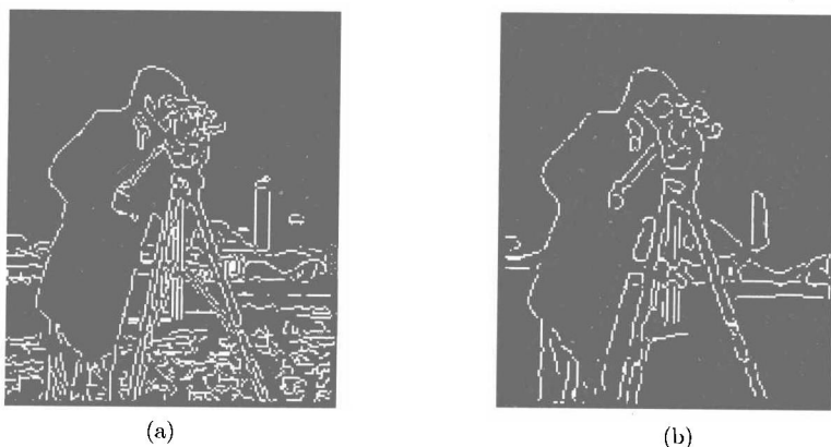
图 1.2 利用 Canny 边缘检测算子对上图检测出的不同尺度下的边缘
