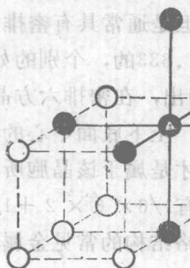
图1.1-8 简单立方晶格配位数示意图
