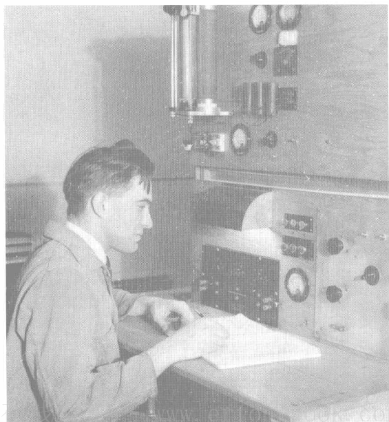
46. 阿尔弗雷德·尼尔用他的质谱仪分离出一块铀 235 样品。哥伦比亚大学用它证实这种稀有的同位素对应于慢中子裂变。
