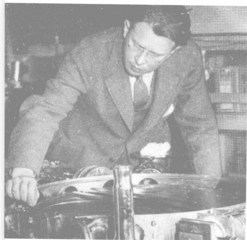
24. 让劳伦斯获诺贝尔奖的回旋加速器击碎了原子核的秘密,证实了一个强有力的中子源。劳伦斯在检测 1937 年完工的直径 94 厘米回旋加速器的真空室。
