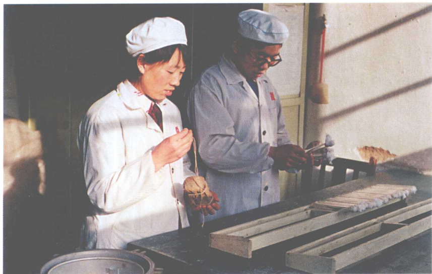
彩图 8 灭菌后趁热摆成斜面 (李志超摄)
