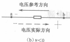
图 1-4 电压的参考方向与实际方向
