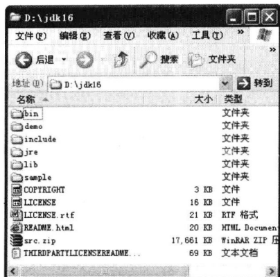
图 1.2 安装 JDK 后的目录结构
