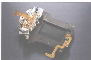
▲高速连拍的四个核心部分——反光镜升降马达、快门开合马达、影像处理器的处理速度及档案由缓冲记忆体到外置记忆卡的存取速度。
