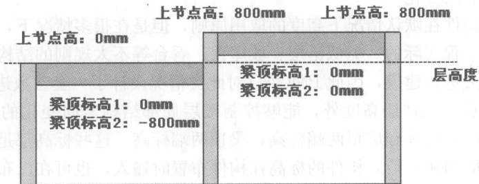
图 1-8 梁顶标高与上节点高共同控制梁位置示意
