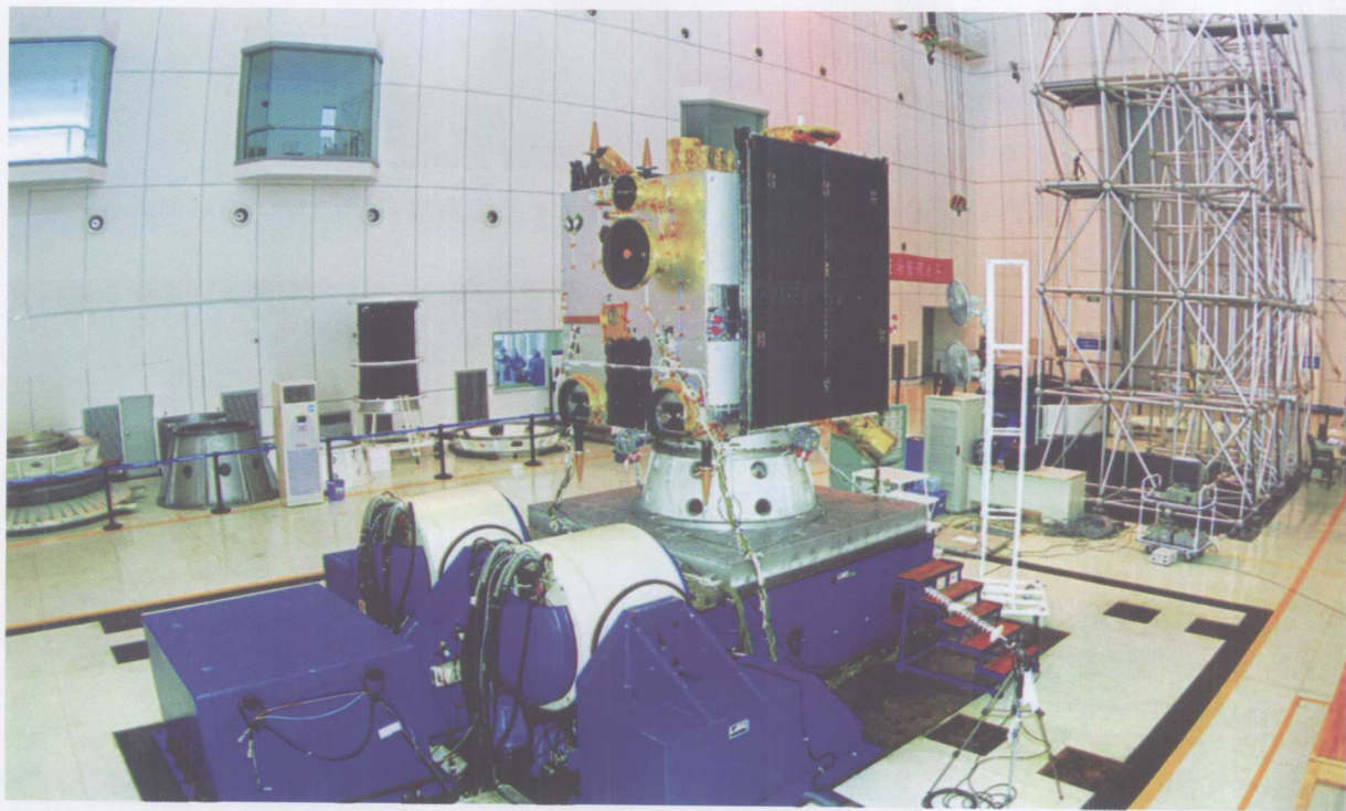
嫦娥一号卫星振动试验
