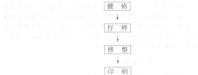
2、工艺特点 三种制版工艺比较，不难看出，制版工艺复杂难以掌握，而且制版的周期最长，成本比较高。但是，这种印刷版的耐印率较高，而且所印制出的墨层厚实，能在大幅面的粗质纸、塑料纸承印物、金属箔等上面进行印刷。目前在我国多用在塑印包装印刷上。
