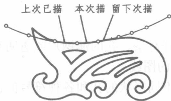
图 P1M1.3 用曲线板描绘曲线
