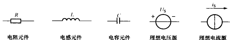
图 1-2 理想电路元件的图形符号
