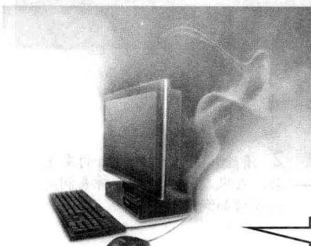
**3 “闻”**就是在检修电脑的过程中，如果闻到了有电线烧焦的刺鼻味道时，应及时切断电脑电源，再将主机打开，通过“看”和“闻”来确定故障的准确部位
