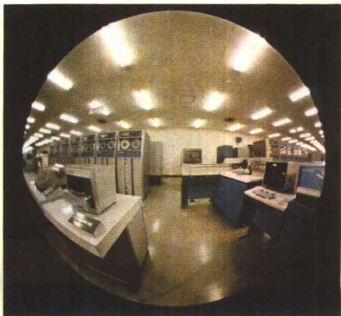
电子计算机工厂内部。采用流水作业方式安装微型电子计算机。 用鱼眼镜头（一百八十度的广角透镜）拍摄的电子计算机的室内全景。最前面是操作台，排列在后面的磁带设备。
