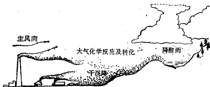
图1.5 形成酸雨的颗粒状硫氧化物、氮氧化物、大气污染物的输送及沉降示意
