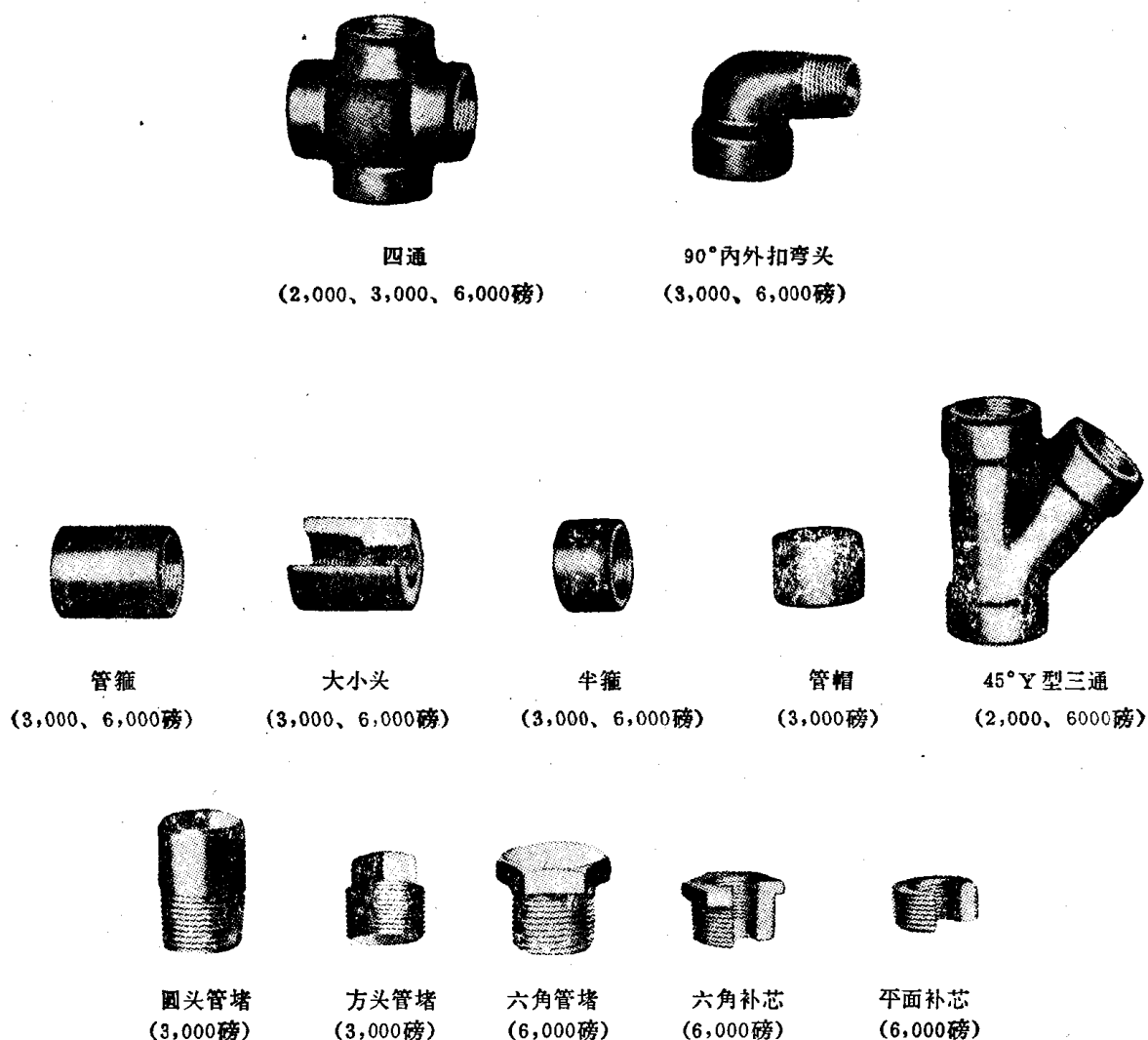
图 1-1 锻钢螺纹管件 (用于2,000、3,000、4,000及6,000磅水、油、气体)
