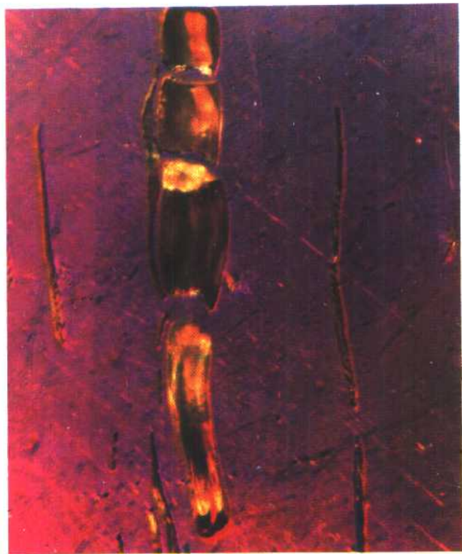
图11—15 硫化锰夹杂，偏光正交下 \times 500 \times 2
