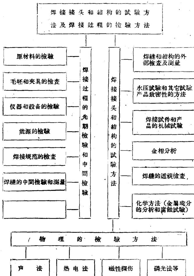
用各种焊接過程的檢驗方法和焊接接頭及結構的試驗方法。例如，焊接合金鋼的化學設備時同時要求焊縫有優良的致密性，這可用透視的方法來檢查，還要求保證焊接接頭有一定的化學耐久性和強度；那麼為了檢驗這些性能，就需要再補充作機械試驗和腐蝕試驗，以及焊縫金屬的金相分析。
